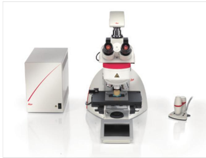
当视频显微镜的遮光器不能准确定位时候，就要考虑一下遮光器固定螺丝是不是松了，或者是定位的弹珠滚出了定位孔，如果要是定位的弹珠不在定位孔，把它让进去然后拧紧固定螺丝就行了，要是拧紧后遮光器转动不灵活，那就需要在遮光板和载物板间放一个垫圈，之大破遮光器转动轻松的时候就可以了。. 当物镜不容易转动和定位时候，要检查一下固定螺丝是不是太紧了，如果太紧了还可能损坏零件，如果松了轴承弹珠就会滚出来挤到一起，也会转动很困难的，如果弹珠跑到外面就很难找到了，因为它太小了（注意哦），当固定螺丝固定的使转换器容易转动的时候较为多好，根据情况固定就可以了。不容易定位的时候有可能是弹簧片坏了，检查一下，坏了就再换一个就可以解决这个问题了。视频显微镜各种元件的发展趋势逐渐小型化。太原高倍光学显微镜销售
